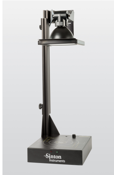
Obrázek 5.2. Přístroj Sinton WCT-120 pro měření efektivní doby života. Nahoře zdroj světla, dole místo pro umístění waferu s vyhodnocovacím obvodem. [77]
